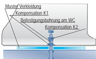
Ausgleichsmuffe K1 auf Haltestäbe aufschieben. Becken auf Haltestäbe absetzen.
