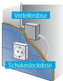
Verteilerdose hinter der Vorwand und einer ausreichend großen Wartungsklappe, die nur mit Werkzeug zu öffnen sein darf, leicht zugänglich anbringen. Ab Verteilerdose hinter der Verkleidung eine Feuchtraumsteckdose mit zugelassenem Kabel vor der Verkleidung
