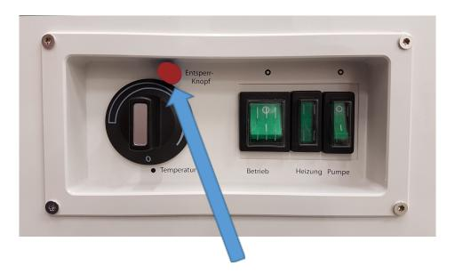
Im Falle eines Defektes, löst das Sicherungselement aus.
